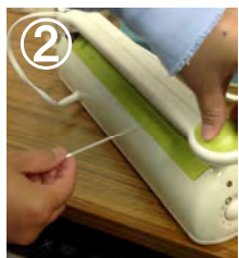
② ストロー管の先端をシーリング。
